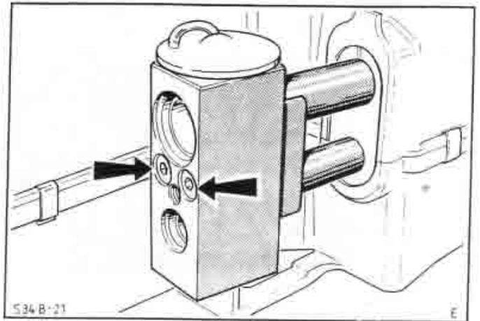
Válvula de expansión termostática y sus tornillos de fijación.
