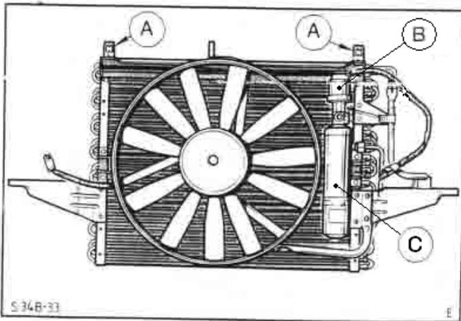
Condensador y Ventilador auxiliar.
